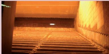
Verbrennung von 18 Tonnen pro Stunde auf einem wassergekühlten Vorschubrost.
